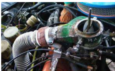
Válvula AFR abierta para gasolina/GNC.
