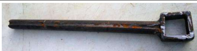
Barra limpia-tobera con ranura para el cañito de agua, el cuadrado es para aflojar los tapones.
