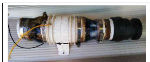
Soplador tipo Bilge blower 12 VCC.
